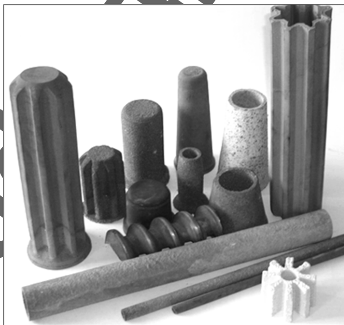
Рисунок 5.4 - Пористые порошковые материалы различной формы и размеров
