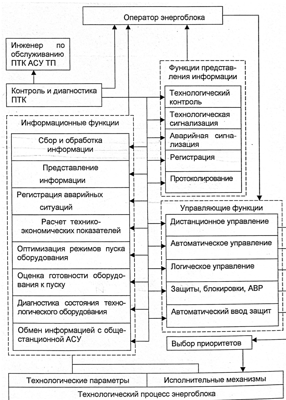
Рисунок 2.48 - Функциональная схема АСУ ТП блока
